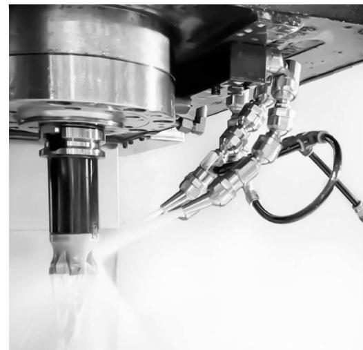
て「サイクルタイム」「工具寿命」「仕上げ面精度」などに課題が発生してしまう。これまでこうした状況を開拓するために、これまで高圧のポンプに切り替えるという施策がとられてきたが近年、世界的に早急な環境対策が叫ばれる中で、高圧ポンプの使用によるCO<sub>2</sub>排出量の多さが懸念事項となっている実情がある。
