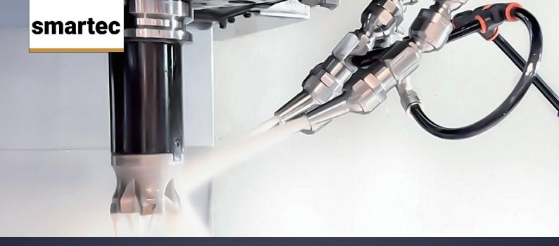
Aeroforce (エアロフォース) は、クーラント にエアをプラスして使う次世代型のハイパ ワークーラントシステムです。高圧クーラントで 切りくずを除去したいとのニーズは強いもの の、高圧クーラントは初期投資が大きく、設置 工事も大がかりです。エアロフォースは、工場
