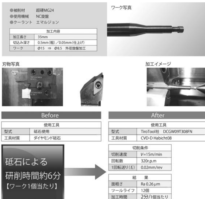
図6 超硬における加工事例
