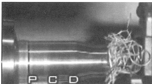
写真2 切りくずがつながった状態 (従来のPCDインサートによる加工)
